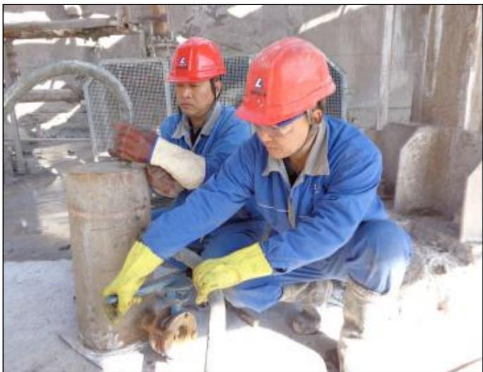
近日,第一氧化铝厂精制车间党员宋治文、郝卫东对“减少风镐磨损率”课题进行攻关。他们将废弃钢管和小蝶阀加工成“高压风净化器”,成功滤去高压风里的水份与杂质,提高了劳动质量,降低了风镐的消耗。图为车间党员加工完善“高压风净化器”现场。
